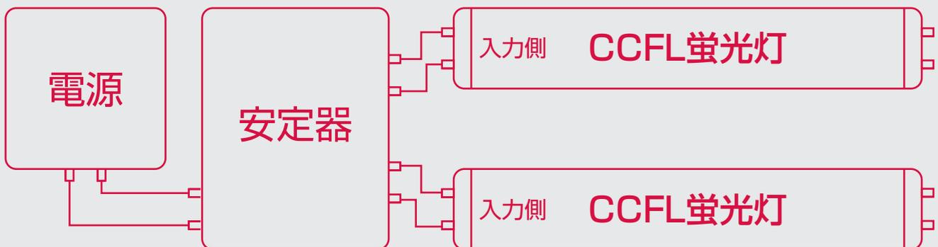
※CCFL蛍光灯は片側給電ですので、ランプに表示された取付方向を確認してください。万一、取付方向を間違われても、ランプ破損や漏電には至りません。
