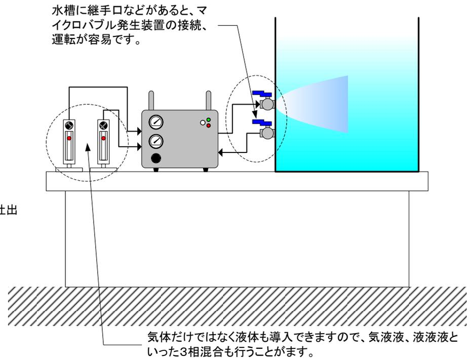
気体/液体流量計(調整弁付)
